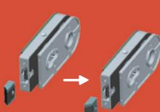
DIN rechts. Nun befestigen Sie die Schlosskappen mittels der Schraubbuchsen! (Abb.1)
